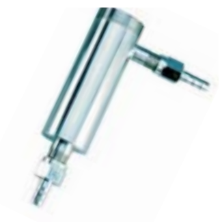
名称：流通式护套 型号：HL-300A 材质：316不锈钢 插入深度：150mm 连接螺纹：PG13.5螺纹
